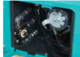
切替え容易なマルチコントロール、 N&Bセレクト(前面左下部)。
