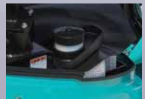
取り外して丸洗いでできる樹脂製燃料タンク。
