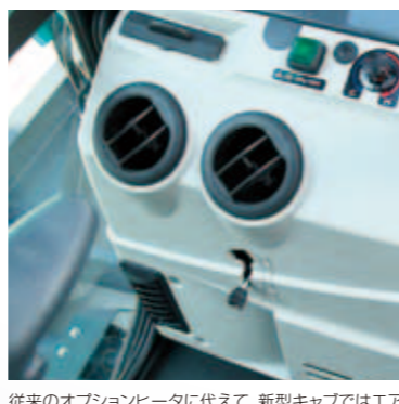
従来のオプションヒータに代えて、新型キャブではエア コンを標準設定。夏の猛暑日も真冬日も快適に作業可 能。エアコンユニットは足元右配置で後方視界もワイド です。
